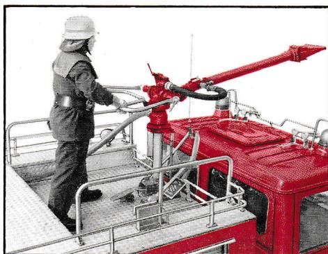
Eine geräumige Standmulde am Monitor mit seitlichen Haltebügeln geben dem Feuerwehrmann ein Höchstmaß an Sicherheit im Einsatz.
